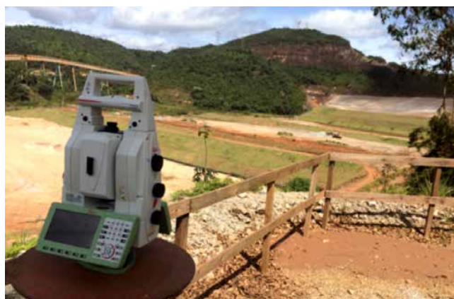
Figura 1 – Estação total robótica realizando monitoramento de campanha na barragem Sela na mineradora Samarco
